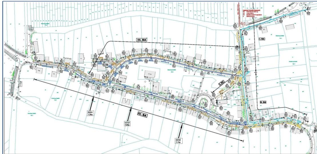
Verbesserung der abwassertechnischen Situation in der Trinkwasserschutzzone III durch Neubau eines Schmutz- und Regenwasserkanals in der Ortslage Saalfeld. Überleitung des anfallenden Schmutzwassers in die Ortskanalisation von Windeberg und damit zur Kläranlage in Mühlhausen.
